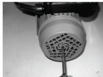
Afin d'éviter le blocage de la garniture mécanique, faire tourner l'axe par le ventilateur avant mise en marche ou après arrêt prolongé.
