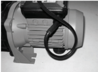
CORRECT! Evitez l'entrée de l'eau par le câble électrique.
